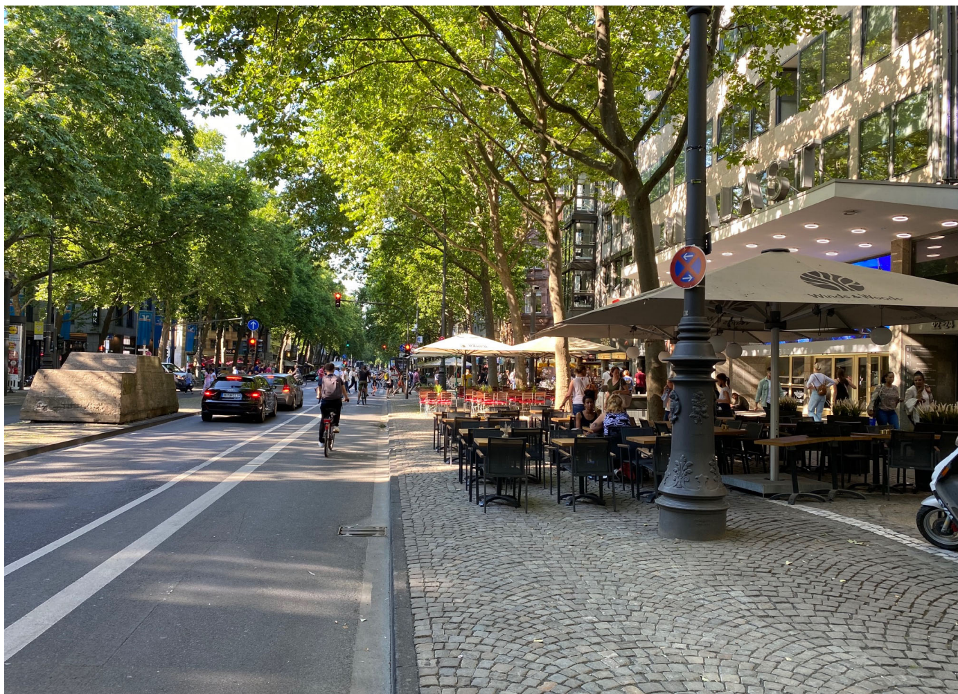
Bild 72 | Aufenthalt und Außergastronomie: die Verlagerung des Radverkehrs vom Seitenraum auf die Fahrbahn und angepasste Neugestaltung der Flächen haben die Aufenthaltsqualität, die Bedingungen für den Fußverkehr und die Erreichbarkeit der anrainenden Nutzungen auf den Kölner Ringen in vielen Bereichen nachhaltig verbessert
