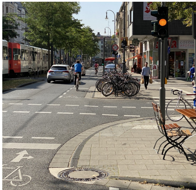
Bild 38 | Sondersignalisierung für Radfahrende: angepasst an die geringere Fahrgeschwindigkeit zeigt ein Zusatzsignal für Radfahrende in einem aufgeweiteten Knotenpunkt noch „Grün“, während das Hauptsignal bereits auf „Gelb“ umspringt
