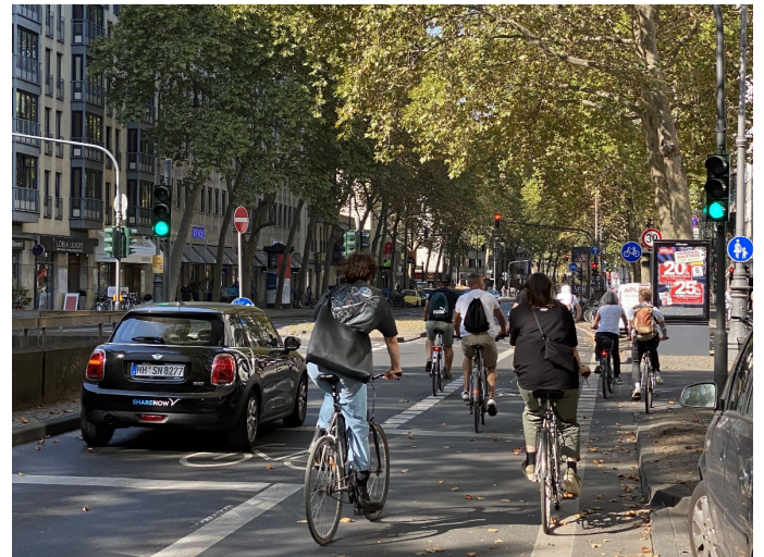
Bilder 70 und 71 | Erste Hinweise auf Kapazitätsengpässe: das weiterhin steigende Aufkommen und die verschiedenen Fahrgeschwindigkeiten im Radverkehr führen – nicht nur auf den Ringen – mittlerweile selbst auf dem breiten Radfahrstreifen zu mehrspurigem Fahrverhalten und Überholvorgängen zwischen Radfahrenden wie auch zur Mitnutzung des parallelen Kfz-Fahrstreifens durch schnelle Radfahrende
