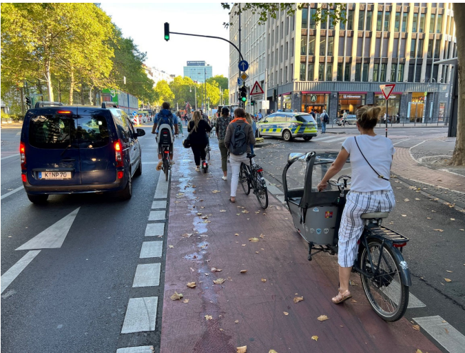
Bilder 70 und 71 | Erste Hinweise auf Kapazitätsengpässe: das weiterhin steigende Aufkommen und die verschiedenen Fahrgeschwindigkeiten im Radverkehr führen – nicht nur auf den Ringen – mittlerweile selbst auf dem breiten Radfahrstreifen zu mehrspurigem Fahrverhalten und Überholvorgängen zwischen Radfahrenden wie auch zur Mitnutzung des parallelen Kfz-Fahrstreifens durch schnelle Radfahrende
