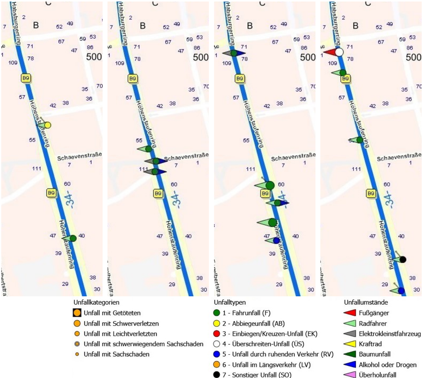
Bild 62 | Unfallentwicklung auf der 2018 realisierten Pilotstrecke: Die EUSKa-Auszüge der Jahre 2020 bis 2023 (von links nach rechts dargestellt) weisen nur sehr wenige Unfälle auf dem rd. 400 langen Pilotstreckenabschnitt aus und betreffen überwiegend Fahrnfälle von Radfahrenden sowie Alleinunfälle mit alkoholisierten E-Scootern
