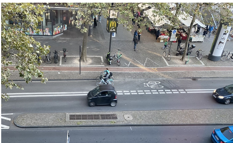
Bild 37 | Verdeutlichung besonderer Zufahrten: hier die Zufahrt zu einer als Fußgängerbereich ausgewiesenen Teilfläche des Rudolfplatzes, der zeitweise als Marktfläche genutzt wird – der vorübergehend mit gelbem „X“ als nicht mehr gültig markierte Radweg im Seitenraum wurde zwischenzeitlich durch Neupflasterung entfernt
