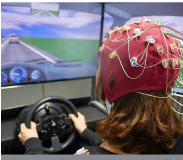
Im Fahrsimulator: Während eines Teils der Versuche wird auch die Hirnaktivität mittels EEG-Kappe gemessen. Foto: IfADo
