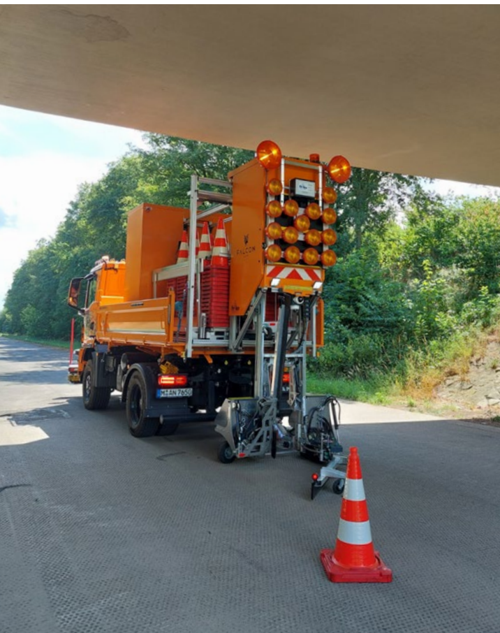
Pylone werden automatisch aufgestellt.
