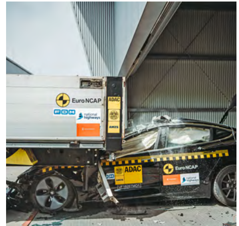
Ein Fahrzeug fährt mit 56 km/h auf ein stehendes Lkw-Gespann.
