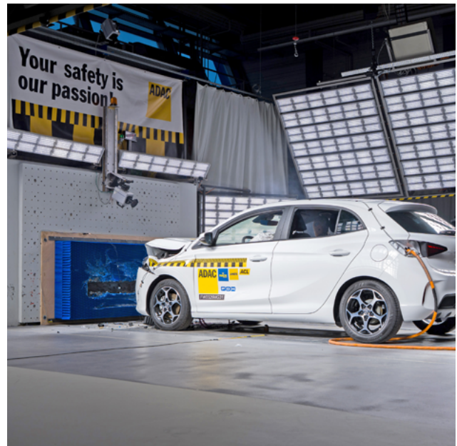
Das Crash-Fahrzeug nach dem Test mit 35 km/h
