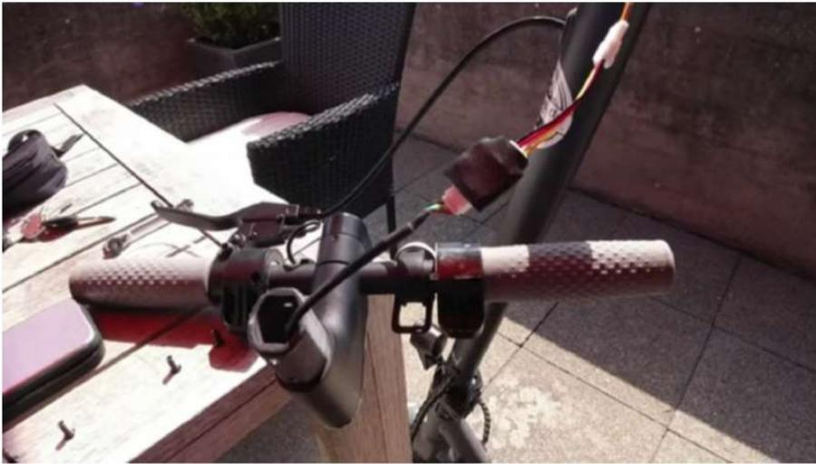
Chip wird durch 6x Betätigen des Powerknopfes aktiviert
