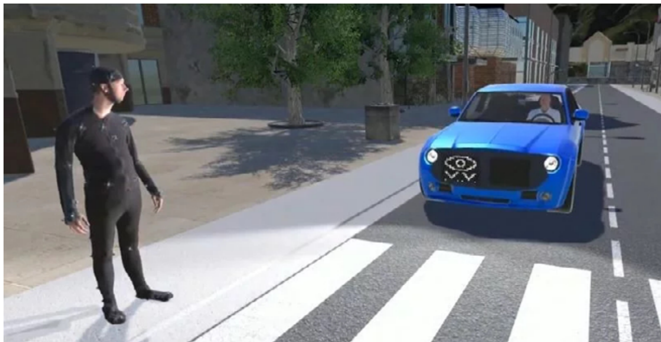
Ein interaktives Display im Fahrzeugkühler sendet Signale an Fußgängerinnen und Fußgänger.
