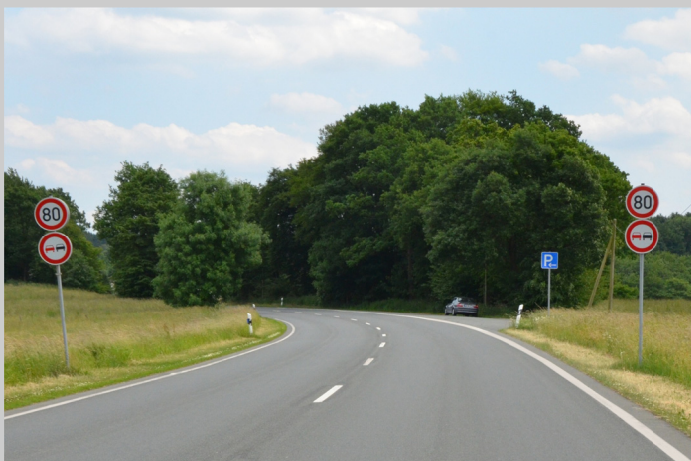
Kombination Überholverbot und Geschwindigkeitsbeschränkung
