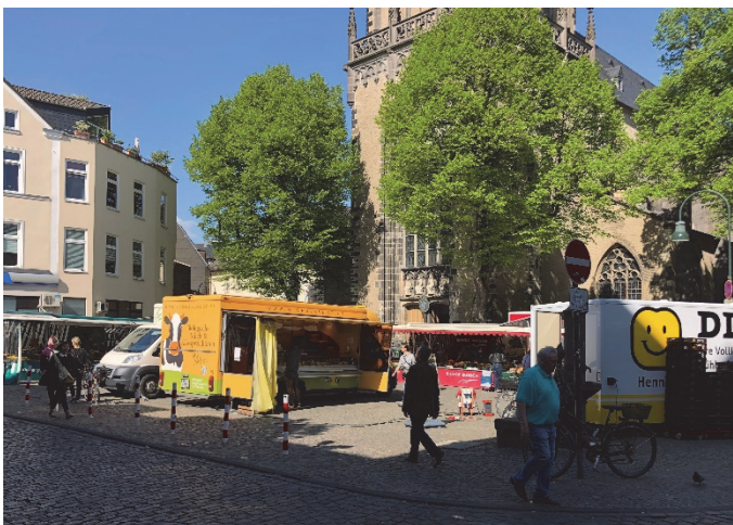
Bilder 25 bis 28 | Verkehrsflächengestaltung und Platzfunktionen: Großpflaster aus Naturstein für die Fahrbahn, Klein- und Mosaikpflaster mit integrierter Gehbahn in Plattenbelag definieren den Seitenraum, neue Baumpflanzungen schaffen mit dem vorhandenen Baumbestand einen symmetrischen „grünen Rahmen“ für das gesamte Ensemble, Marktstände und Discounter ohne eigene Kundenstellplätze
