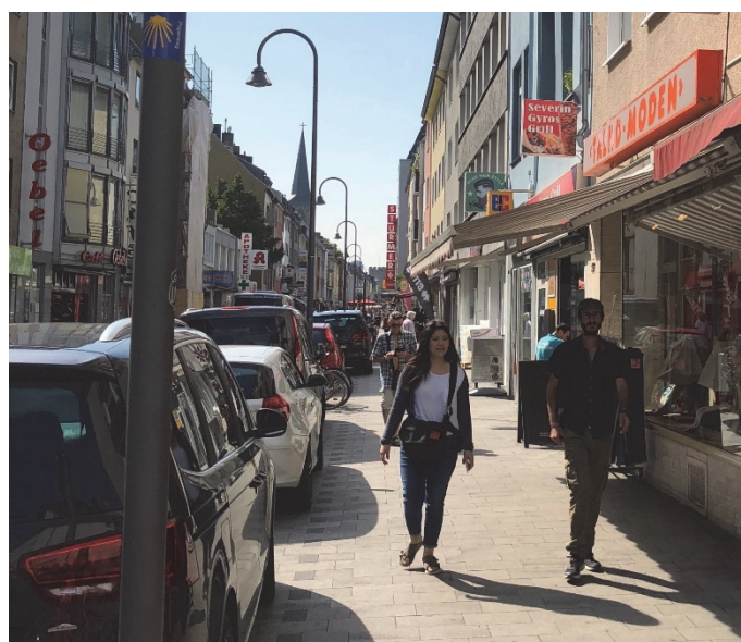
Bilder 20 und 21 | Parkstände: Die Abgrenzung zum Geh- und Aufenthaltsbereich lediglich durch eine Betonsteinmarkierung im Belag wird von den Parkenden gut akzeptiert
