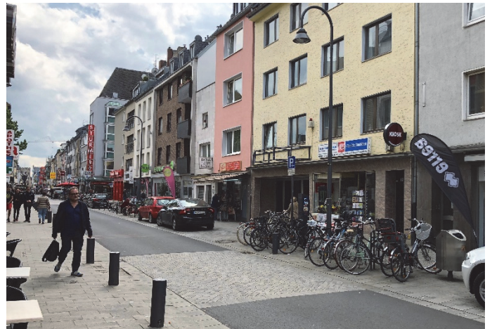
Bilder 13 und 14 | Pflasterflächen als Gliederungselemente in den Streckenabschnitten: Die intendierte Funktion als Überquerungsstelle spielt in der Realität keine Rolle und wird durch das Abstellen von Zweirädern auch weitgehend aufgehoben
