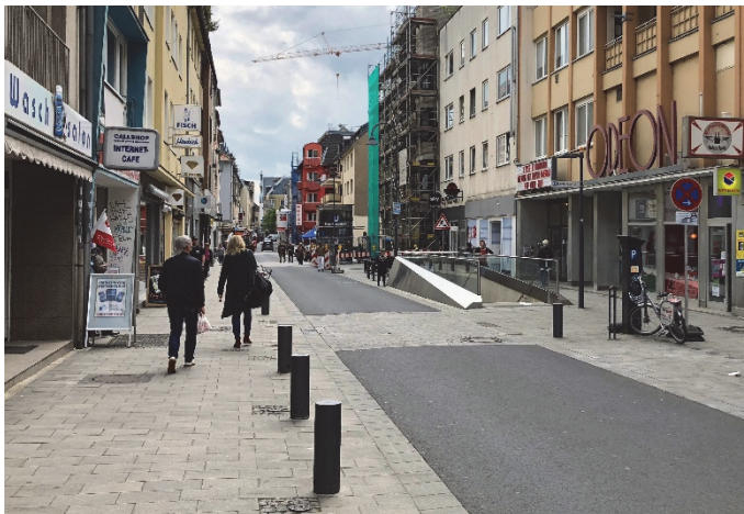
Bilder 13 und 14 | Pflasterflächen als Gliederungselemente in den Streckenabschnitten: Die intendierte Funktion als Überquerungsstelle spielt in der Realität keine Rolle und wird durch das Abstellen von Zweirädern auch weitgehend aufgehoben
