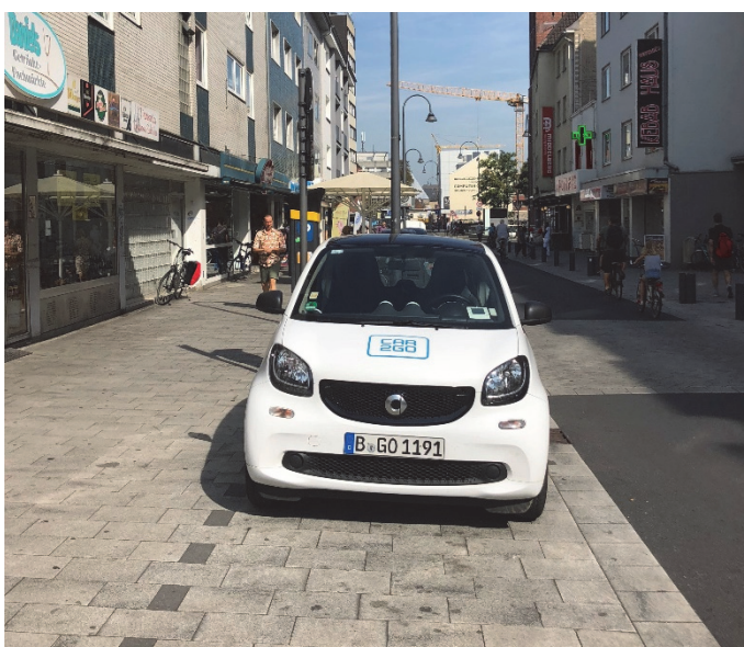
Bilder 20 und 21 | Parkstände: Die Abgrenzung zum Geh- und Aufenthaltsbereich lediglich durch eine Betonsteinmarkierung im Belag wird von den Parkenden gut akzeptiert
