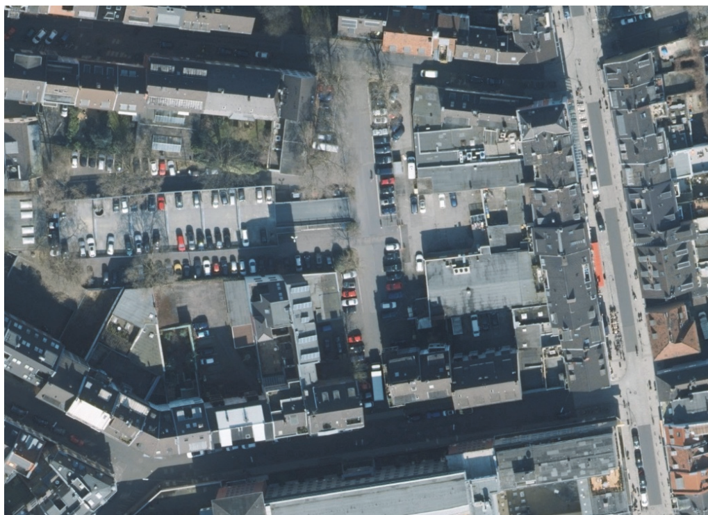
Bild 5 | Vorbedingung für die Umgestaltung: Errichtung einer Parkpalette in akzeptabler Gehentfernung zur Kompensation wegfallender Parkstände im Straßenraum – rechts im Luftbild die umgestaltete Severinstraße, links mittig die Parkpalette über dem zuvor bereits vorhandenen und gleichzeitig neu geordneten Parkplatz
