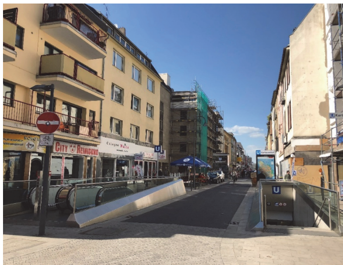
Bilder 29 und 30 | Zugänge zur Stadtbahnhaltestelle: Rolltreppenanlage, Treppenanlage und gläserner Personenaufzug mit transparentem „Schaufenster“ nach unten
