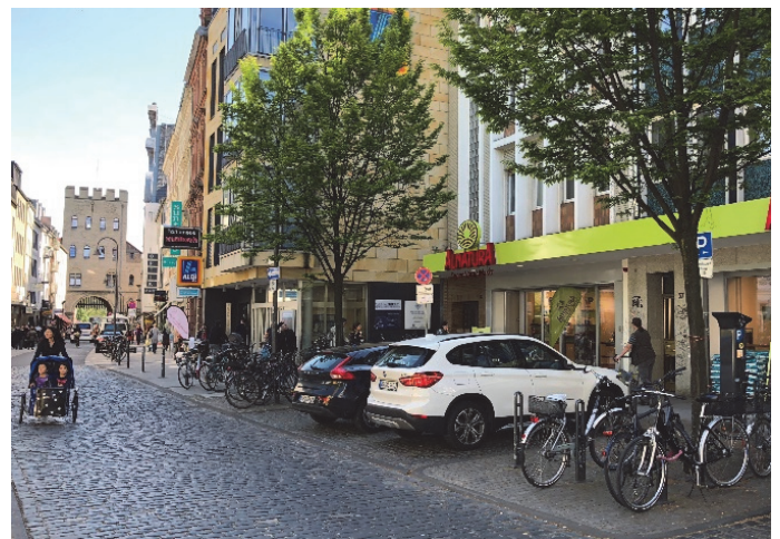
Bilder 25 bis 28 | Verkehrsflächengestaltung und Platzfunktionen: Großpflaster aus Naturstein für die Fahrbahn, Klein- und Mosaikpflaster mit integrierter Gehbahn in Plattenbelag definieren den Seitenraum, neue Baumpflanzungen schaffen mit dem vorhandenen Baumbestand einen symmetrischen „grünen Rahmen“ für das gesamte Ensemble, Marktstände und Discounter ohne eigene Kundenstellplätze
