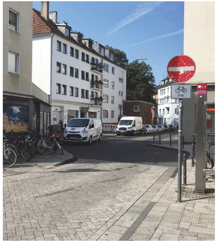
Bilder 11 bis 12 | Einbindung der Seitenstraßeneinmündungen: Einengung der Fahrbahn und im Material angepasste Umgestaltung der Einmündungsbereiche zur Verdeutlichung der Kontinuität der Gehbereiche entlang der Severinstraße
