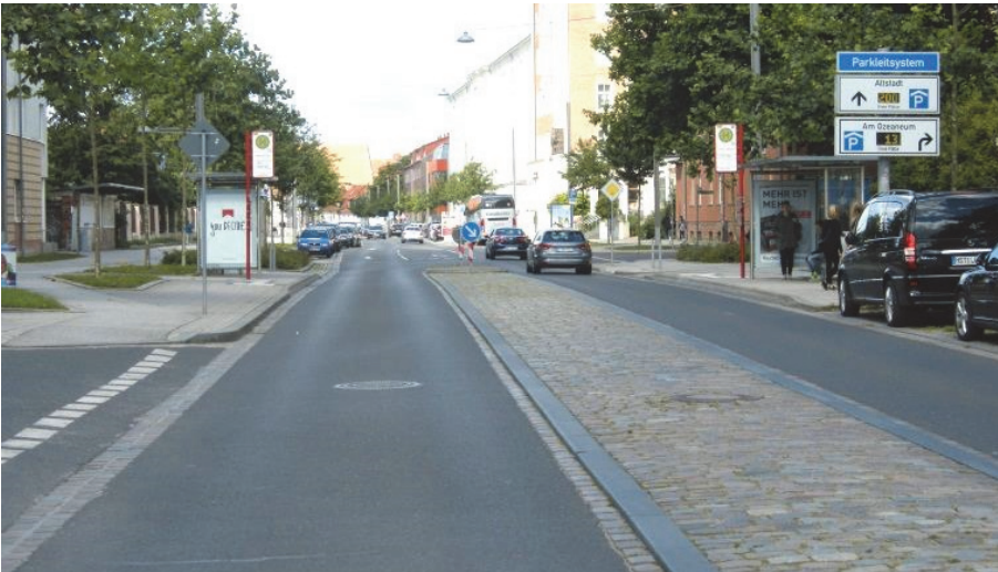
Bild 23 | Bushaltestelle im zentralen Versorgungsbereich: barrierefrei gestaltet mit Mittelinsel als Querungshilfe im Zuge des gepflasterten Mittelstreifens und ausreichendem Platz für Witterungsschutz und Wartefläche aufgrund der Kapausführung
