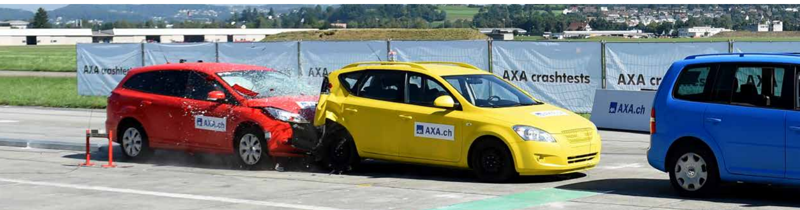
Simulation eines schweren Auffahrunfalls: mit 60 km/h ins Stauende Fotos: AXA
