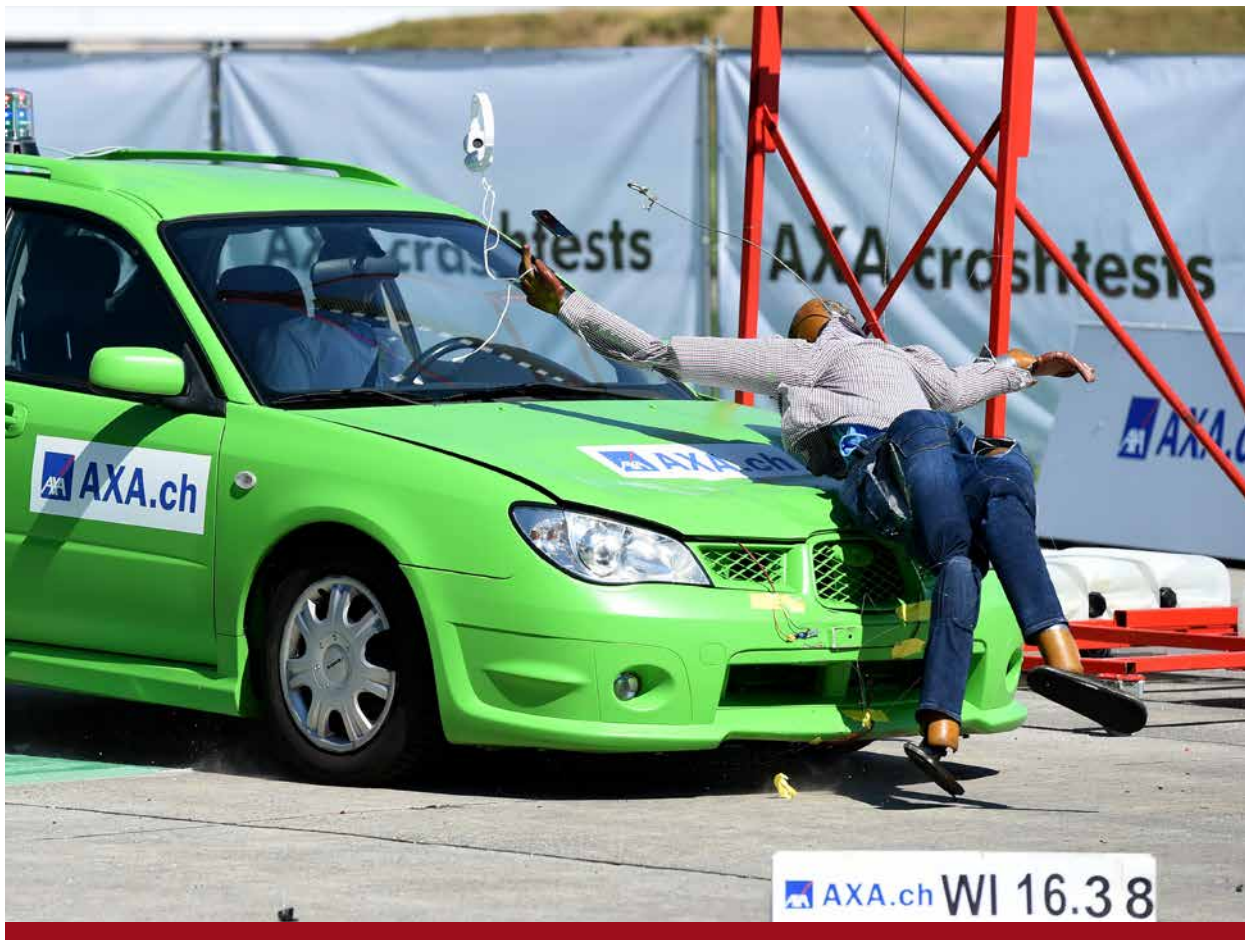
Der Pkw trifft den Fußgänger-Dummy mit 50 km/h.
