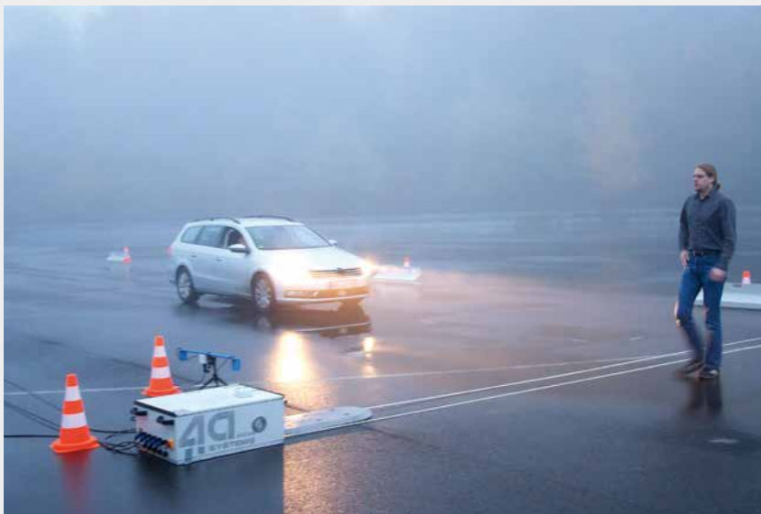
Messung der menschlichen Radarrückstrahlung im Vergleich mit dem Dummy
