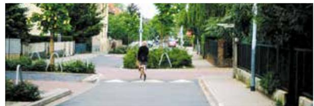
+ Mehr Sicherheit beim Überqueren der Fahrbahnen bringen vor allem Mittelinseln oder Mittelstreifen, an denen die zu Fuß Gehenden kürzere Überquerungszeiten haben und wo sie jeweils nur eine Fahrtrichtung überblicken müssen.
