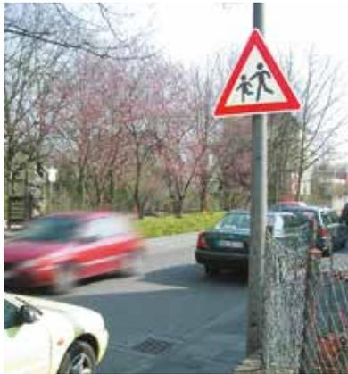
+ Niedrigere Geschwindigkeiten und besserer Sichtkontakt lassen sich auch durch verschwenkte Fahrbahnen erreichen. Diese so genannten Versätze entstehen beispielsweise dadurch, dass das Parken abwechselnd auf nur einer Straßenseite erlaubt wird.
