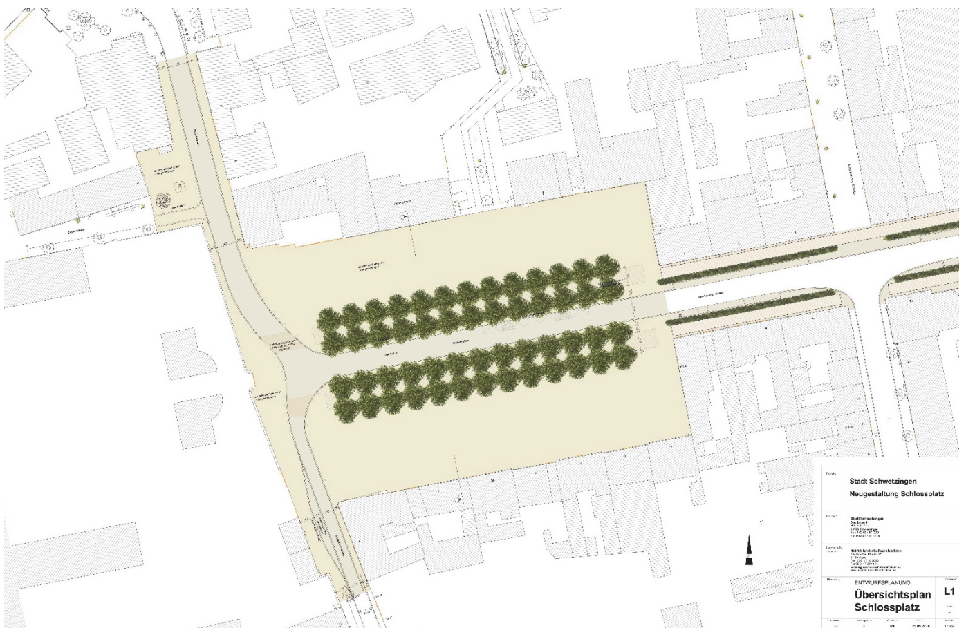
Bild 6 | Der Schlossplatz im Lageplan: symmetrische, axial auf die Carl-Theodor-Straße und das Schloss ausgerichtete Platzgestaltung mit geführten Fahrbereichen für den Kfz-, Bus- und Radverkehr
