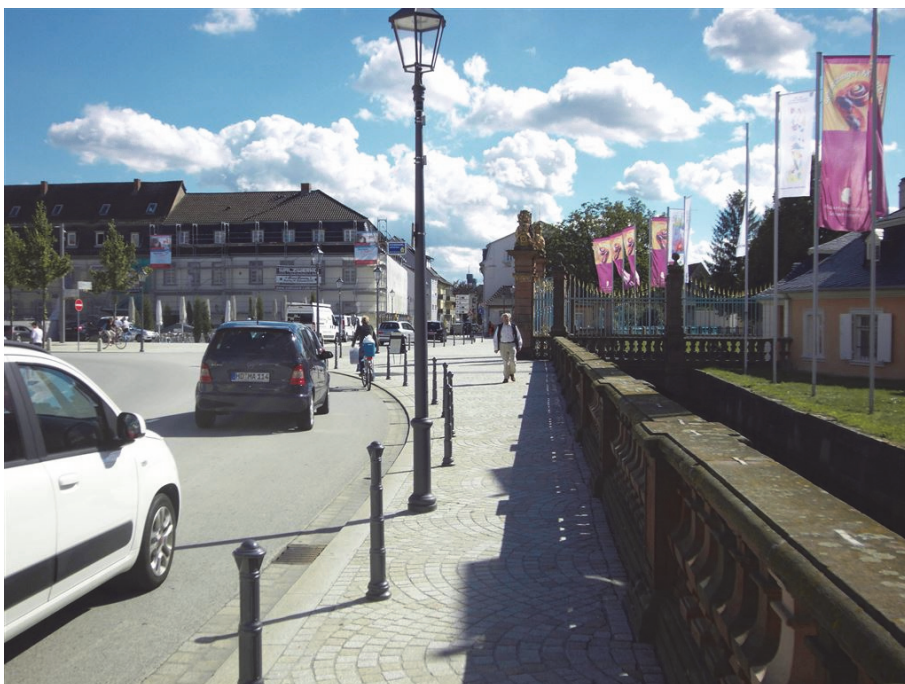
Bild 9 | Verschwenkung des Fahrbereichs vor dem Schloss: Gehbereiche nahe den Regularien für Gehwege nach RAS (Breiten: 2,00-2,50 m) weiten sich im Vorbereich am Hauptportal zu Schloss und Schlossgarten deutlich auf
