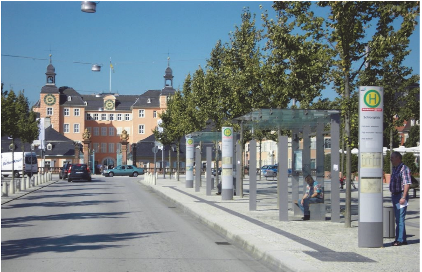
Bild 14 | Zentrale Bushaltestelle: transparenter Witterungsschutz erhöht soziale Sicherheit, dunkle Leitelemente auf hellem Pflaster schaffen den nötigen Kontrast für Sehbeeinträchtigte, der Kapbordstein ermöglicht einen barrierefreien Ein- und Ausstieg
