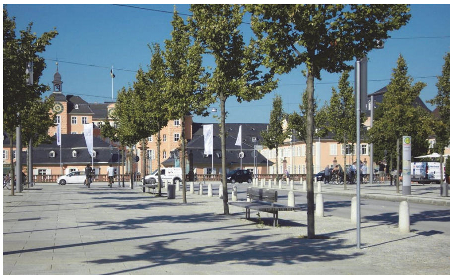
Bild 10 | „Distanzstreifen“ neben dem Fahrbereich auf der zentralen Achse: Platz für Poller, Sitzbänke, Schildermasten, Sitzgelegenheiten und „innere“ Baumreihe der doppelreihigen Allee; unmittelbar angrenzend die fußläufige Promenade
