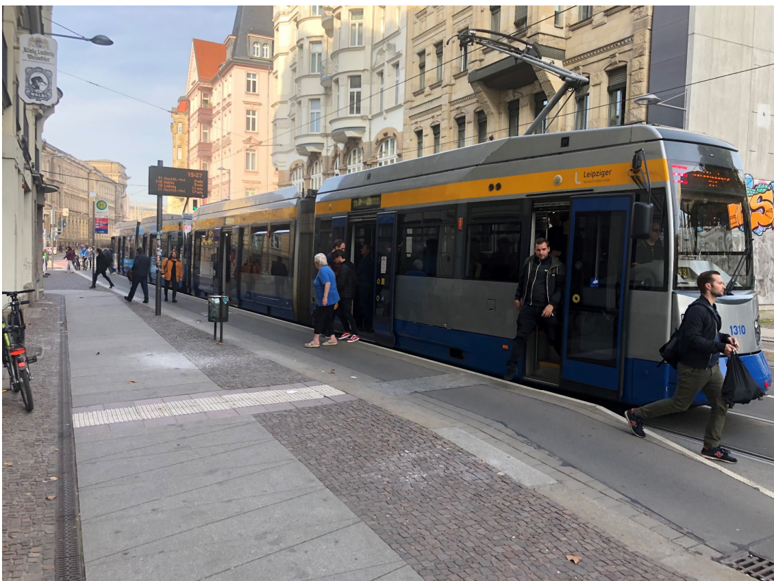
Bild 19 | Haltestelle „Münzplatz“ während eines Straßenbahnhalts: Aussteigende Fahrgäste queren über den schmalen, angehobenen Radfahrstreifen in den Seitenraum, Radfahrende halten weiter hinten im Bild erkennbar an der Rampe, Warte- und Gehfläche sind im Material deutlich voneinander unterscheidbar ausgelegt, für einen Witterungsschutz gibt es einen Fahrgastunterstand am hinteren Haltestellenende in Flucht der Häuserreihe (vgl. auch auf dem Lageplan in Bild 18)
