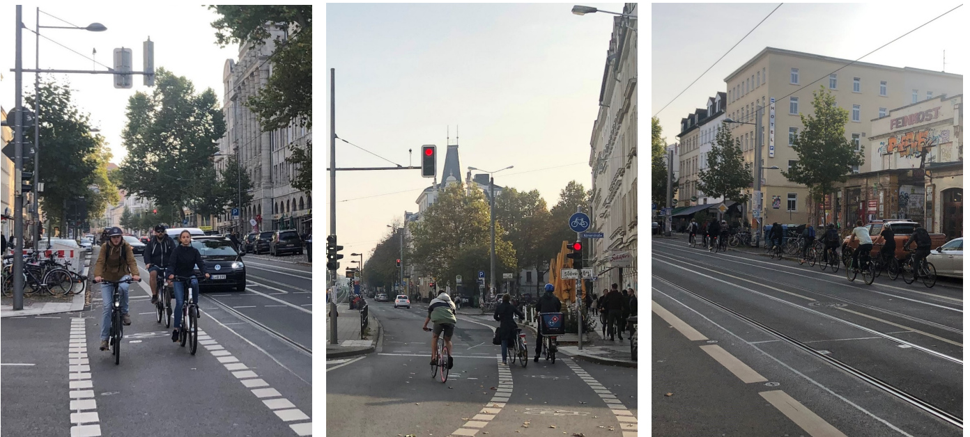
Bilder 61 bis 63 | Nutzungsverhalten auf dem Radfahrstreifen: Das gegebene hohe Radverkehrsaufkommen und das breite Spektrum unterschiedlicher „Typen“ von Radfahrenden (schnell/langsam, regelkonform/regelabweichend) und Ausführungen von Fahrern (führt zu einer Zunahme von Überholvorgängen und nebeneinander Fahrenden, was die Regelbreite des vorhandenen Radfahrstreifens eigentlich nicht zulässt)
