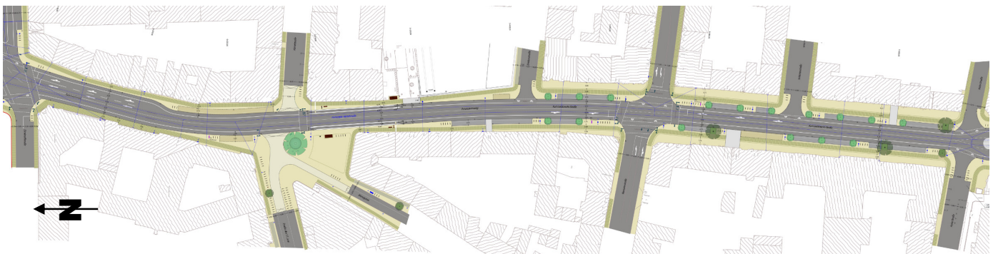
Bild 10 | Abschnitt B: straßenbündige Führung der Straßenbahn gemeinsam mit dem Kfz-Verkehr, Haltestelle „Münzplatz“ mit angehobenem Radfahrstreifen, Längsparkstände nur wo es die Straßenraumbreite zulässt, Baumallee im südlichen Teilabschnitt
