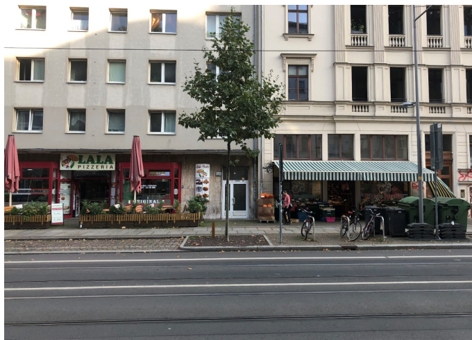
Bilder 40 bis 43 | Variationen der Seitenraumdimensionierung und -nutzung: multifunktionale Teilflächen im „Unterstreifen“ zur Fahrbahn und im „Oberstreifen“ zur Bebauung hin unterstützen eine durchgängig gesicherte Nutzbarkeit der „Gehbahn“ und sichern damit den Fußverkehr entlang der Straße
