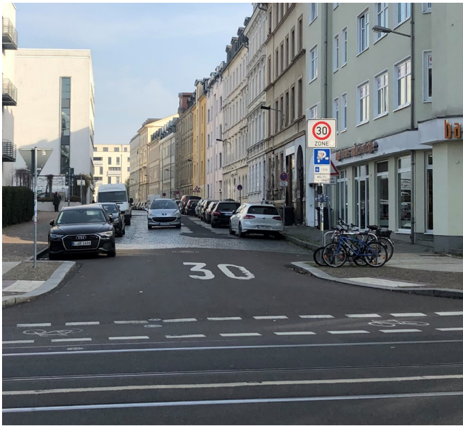
Bilder 29 und 30 | „Leipziger Bügel“ im Seitenraum: Abstellmöglichkeiten für Fahrräder auf der Strecke und an Nebenstraßeneinmündungen außerhalb von Lauflinien Zufußgehender und Sichtdreiecken des ein- und abbiegenden Kfz-Verkehrs
