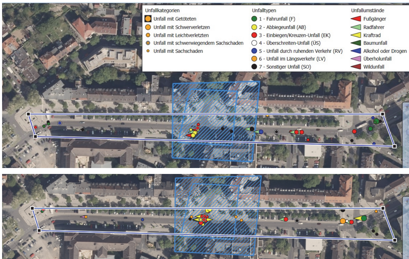
Bilder 43 und 44 | Unfallgeschehen zentralen Abschnitt der Goethestraße unmittelbar vor und nach dem Umbau: Im Vergleich der 3-Jahres-Zeiträume von 2008 bis 2010 (oben) und 2014 bis 2016 (unten) zeigt sich ein nur geringfügiger Rückgang der polizeilich registrierten Verkehrsunfälle, jedoch eine veränderte Unfallstruktur
