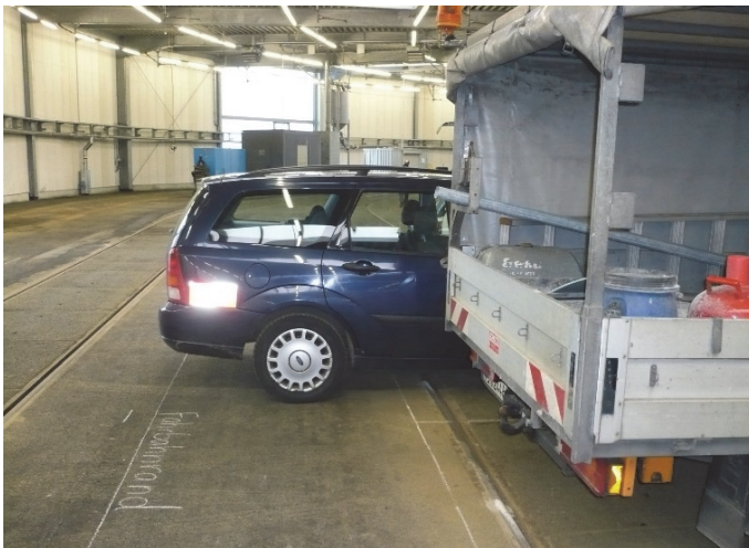
Bilder 19 bis 21 | Senkrechtparkstände in Kombination mit straßenbündigen Straßenbahngleisen: Zunächst im Laborversuch (Bild links) erfolgreich getestet, stellt ein breiter Sicherheitsstreifen auf der Nordseite (Bild links unten) rund 2,60 m Abstand zum äußere Schiene her und verbessert dadurch die Sichtverhältnisse. Auf der Südseite stellen Schutzstreifen und neben liegender Sicherheitsstreifen (Bild rechts unten) einen vergleichbaren Abstand her.
