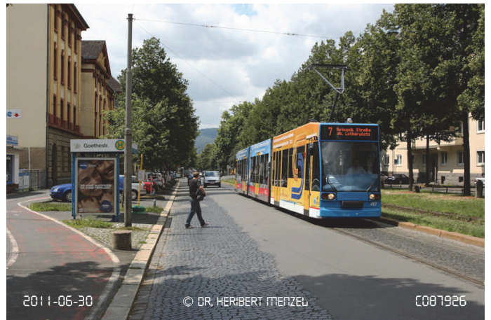
Bilder 11 und 12 | Der lediglich teilsignalisierte Knotenpunkt Goethestraße / Querallee (linkes Bild) ist als Unfallhäufungsstelle langjährig auffällig. Die Straßenbahnhaltestelle ist nicht barrierefrei gestaltet und erfordert an der südlich gelegenen Teilhaltestelle (rechtes Bild) das Ein- und Aussteigen über die Fahrbahn.
