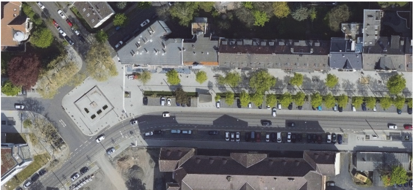
Bilder 13 bis 15 | Alte (ganz oben) und neue Goethestraße (Mitte und unten) in der Draufsicht: Schmale Gehwege und überdimensionierte Fahrverkehrsflächen weichen zugunsten einer breiten Promenade mit dreireihiger Baumallee auf der Nordseite, einer funktional bemessenen zweistreifigen Fahrbahn und attraktiven Platzgestaltungen
