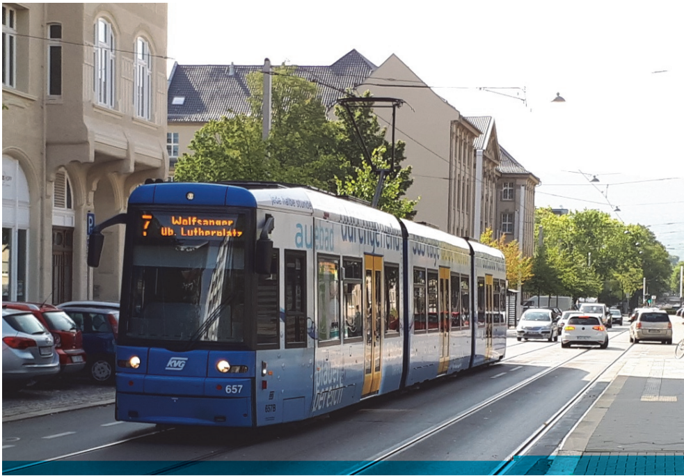
Bild 18 | Straßenbahn als „Pulkführerin“ im Fahrverkehr: Signaltechnisch priorisiert fährt die Straßenbahn vor dem Kfz-Verkehr in den neu gestalteten Straßenabschnitt ein und bleibt dort an der Spitze des Pulks.
