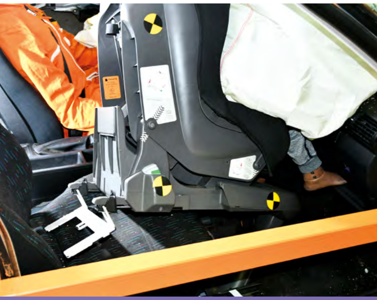
Beim Crash hat sich die ISOFIX-Nachrüstlösung (zur besseren Sichtbarkeit weiß lackiert) aus dem Sitz gelöst. Die Beine des Kinderdummys sind eingeklemmt. Foto: HTW Berlin
