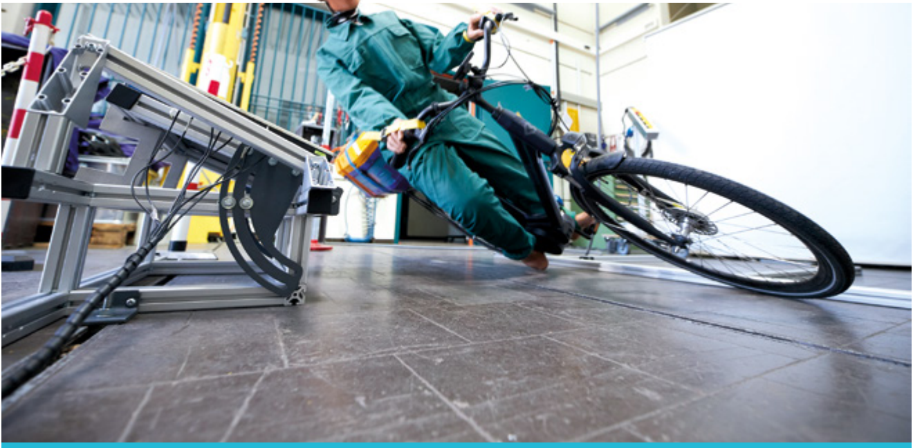
Mithilfe eines Dummys testen die Forschenden die Auswirkungen eines Sturzes. Foto: Dirk Hansen – Territory
