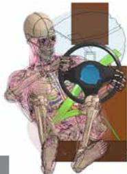
Crashtest-Dummys bekommen zunehmend virtuelle Unterstützung: Computermodelle simulieren das Schutzverhalten der Menschen vor einem Aufprall. Auch Forschende des Fraunhofer-Instituts für Kurzzeitdynamik, Ernst-Mach-Institut (EMI), in Freiburg verwenden bei Crashtests Menschmodelle, die realistischere Aussagen über das Verletzungsrisiko zulassen. Bei ihren Berechnungen rücken sie die Muskelsteifigkeit in den Fokus, die bei bisherigen Untersuchungen nicht berücksichtigt wurde.
