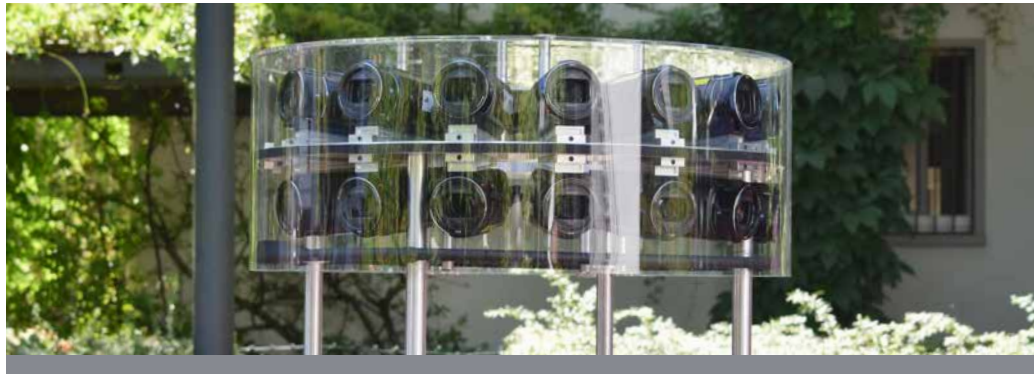
16 UHD-Einzelkameras mit 4K-Auflösung zeichnen Vorgänge gleichzeitig rundum in zwei Ebenen auf und liefern stufenlose Bilder Foto: Werner Schlegel
