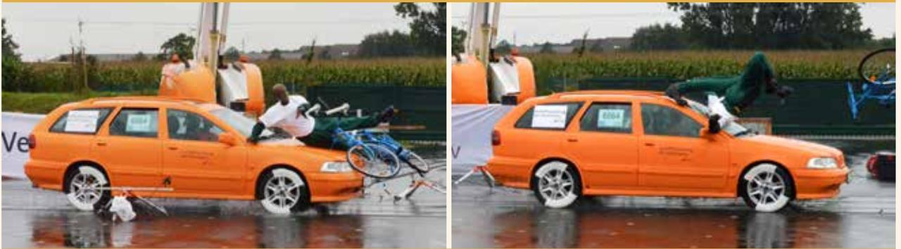
Ein spezieller Airbag am Scheibenrahmen und ein automatisches Notbremssystem versprechen den größten Sicherheitsgewinn für Radfahrer.
