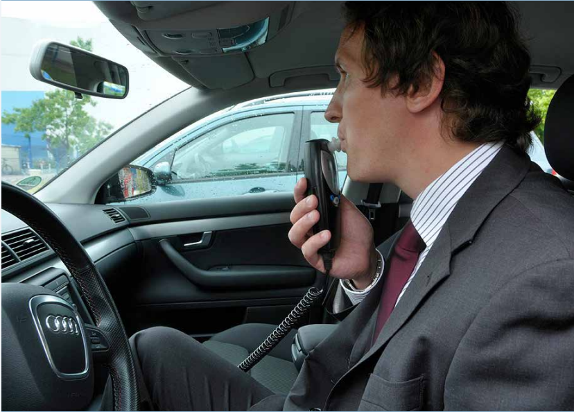
Alkohol-Interlock-System: Atemkontrolle vor dem Start
