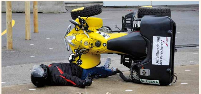
Ein typischer Unfall: Ein Quad verlässt mit 53,6 km/h die Fahrbahn in einer Kurve und kollidiert mit einer Baumreihe.
