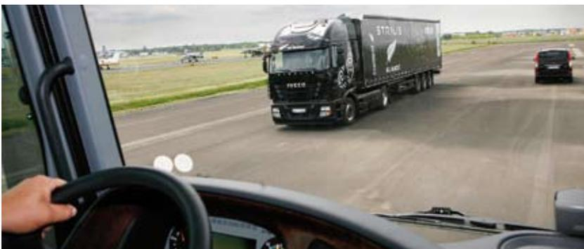
Blick aus der mit einem Notbremsassistenten ausgestatteten Mercedes-Zugmaschine auf ein langsam vorausfahrendes Fahrzeug
