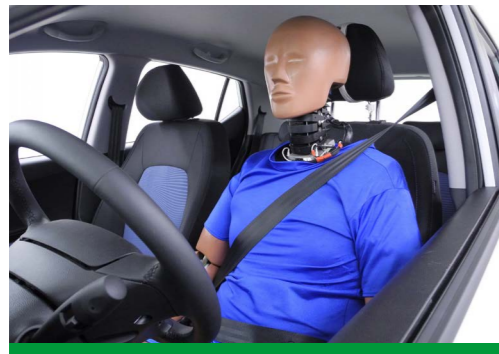
Exakt eingemessen und bereit für den Heckaufprall: der „BioRid-II“-Dummy Foto: AZT
