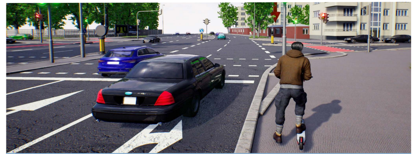
Screenshot aus einer Fahr-/Verkehrssimulation, in der die automatisierten Fahrfunktionen virtuell getestet werden können. Bild: Projekt SAVE / Phantasma Labs
